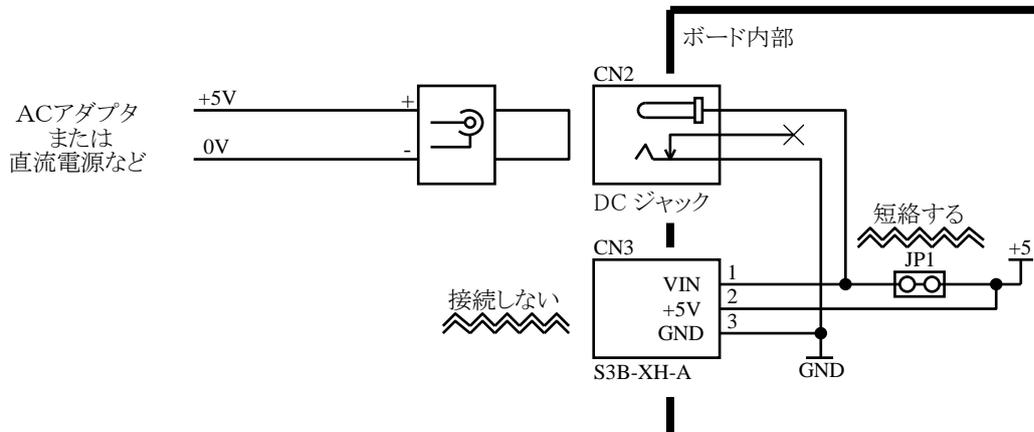
（接続例 2）CN2 から電源供給をおこなう場合（外部電源スイッチを使用する場合）
